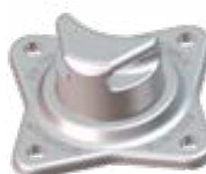
Renvoi d'angle alu orientable Tous les 15 mètres maximum 4 trous entraxe 100 mm
