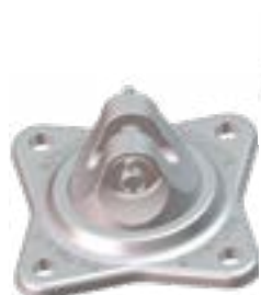
Extrémité alu orientable 4 trous entraxe 100 mm Fixations M10 ou m12
