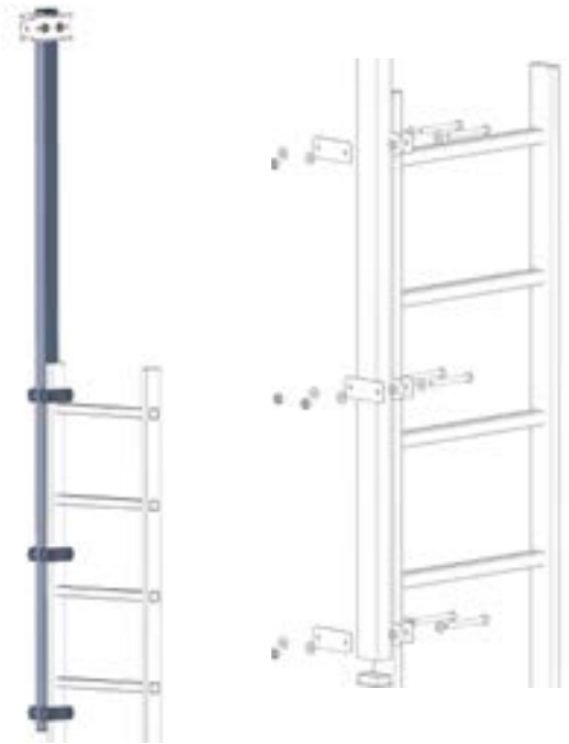
Mat d'extension à brider sur échelle Fixé sur un montant de l'échelle
