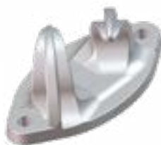
Intermédiaire alu Tous les 15 mètres maximum 2 trous entraxe 100 mm Fixations M10 ou m12
